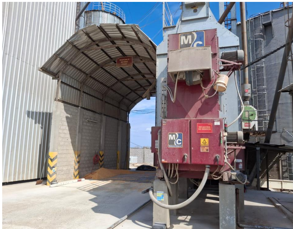
Ilustración 1.11. Secadora de maíz
